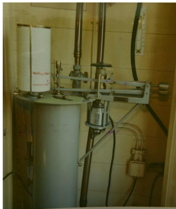
De 'Dines' in het voormalige kantoor van 'De Windwijzer'. De onderste registratie is van de windrichting, aangedreven door de zilverkleurige servomotor, die de twee lange grijze "weegschaal-armen" (met rechts contragewichten) aandrijft voor het overbrengen van de bewegingen van de windwijzer. De twee dikke slangen tegen de achterwand zijn verbonden met de stuwbuis en de zuigbuis van de windwijzer.
